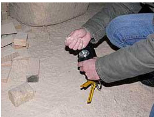
Vochtigheidsmeter voor het meten van zaagsel, hooi, stro, etc.
