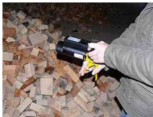
Zaagselvochtigheidsmeter met afgeschroefde vulkamer
