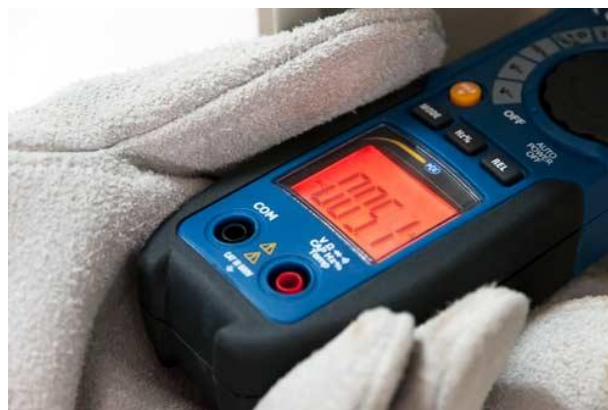
Meting van de stroom in een verdeelkast
