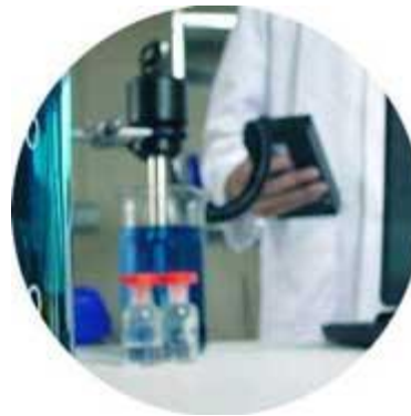
Meetinstrument voor de bepaling van viscositeit in productielaboratoria
