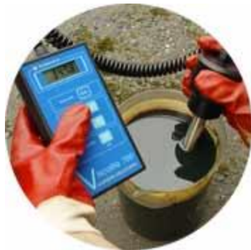
Meetinstrument voor de bepaling van viscositeit bij slib
