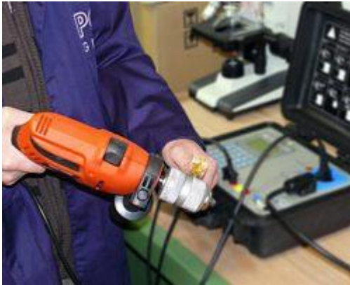
De tester VDE Safetytest 1N tijdens het controleren van een boor
