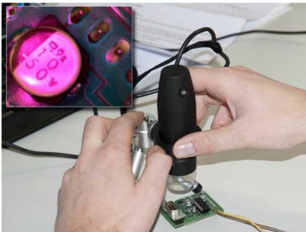
De UV-USB-Microscoop PCE-MM 200UV bij het bekijken van een moederbord.
