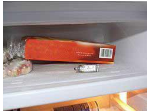
De universele trillingsmeter PCE-MSR 145 bij de controle van de koeling van een koelcel.
