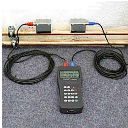
De ultrasonische flowmeter PCE-TDS 100HS bij een meting een pijpleidingsysteem
