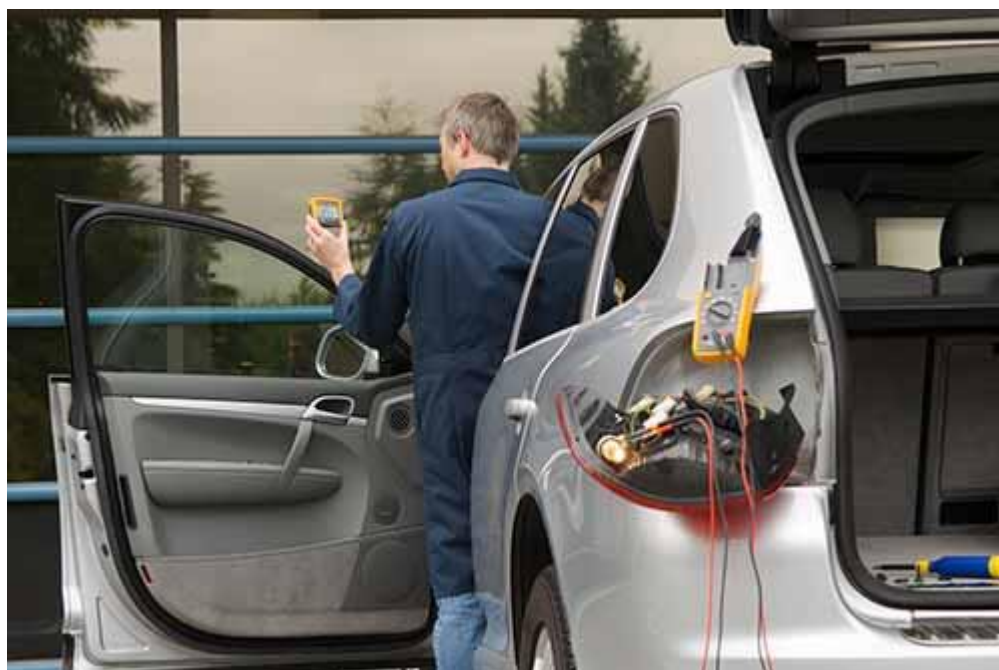
De TRMS Multimeter FLUKE 233 tijdens controle van de spanning van het remlicht
