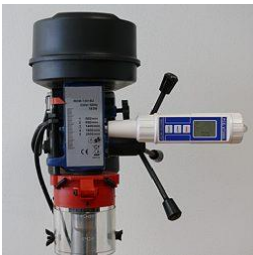
Hier ziet u de trillingstester bij een test van een boormachine
