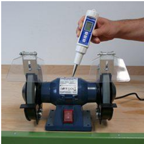
Hier ziet u de trillingstester bij een test aan een slijtmachine.
