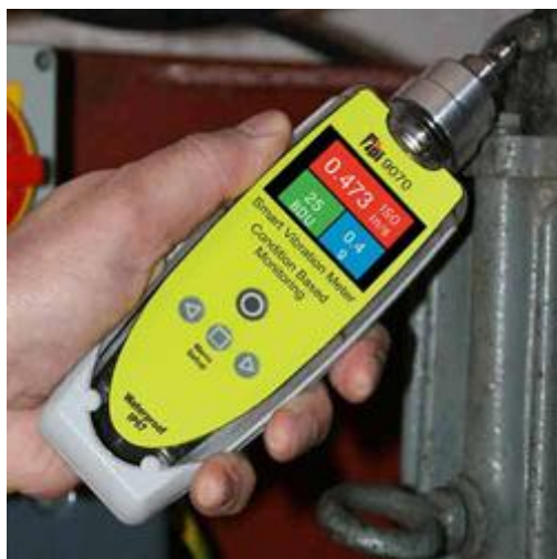
Meting met de trillingsmeter TPI 9070
