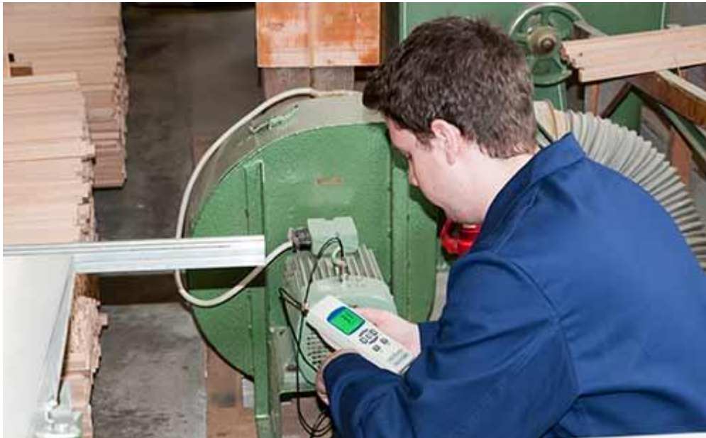
Trillingsmeter PCE-VT 2800 tijdens de controle van een motor
