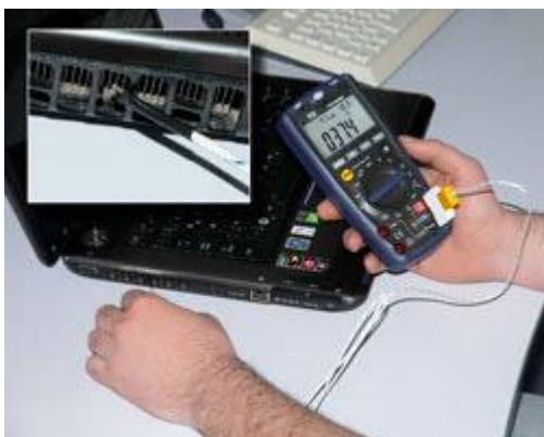
De thermo-hygrometer bij het controleren van een temperatuurmeting met een K-type sensor
