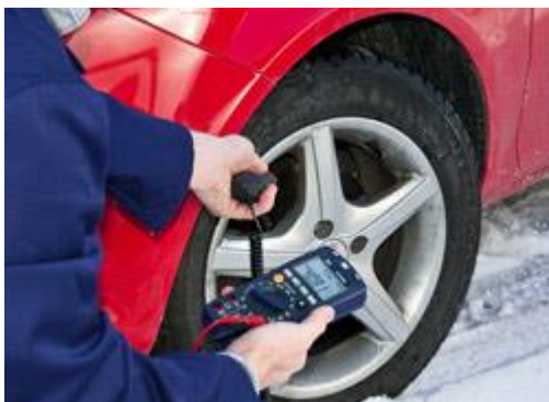
Temperatuurmeting met de externe infrarode temperatuuradapter
