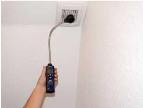
De thermo-anemometer met vleugelwiel PCE-TA 30 terwijl hij een meting verricht in een afzuigkap.
