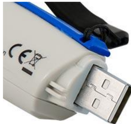
Dankzij de USB interface kunnen de, in de temperatuur datalogger opgeslagen gegevens, op een PC worden geanalyseerd.
