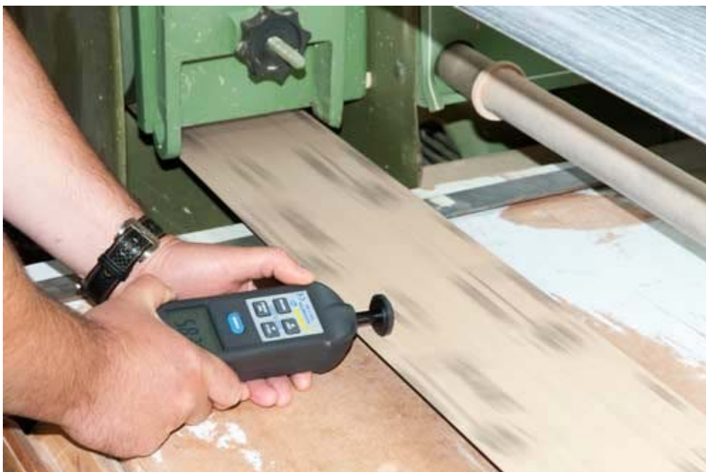
De Tachometer-Stroboscoop PCE-T 260 bij de contactmeting van de loopsnelheid van een slijpband
