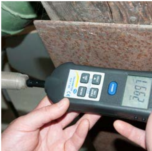
De Tachometer-Stroboscoop PCE-T 260 bij de toerental-contactmeting
