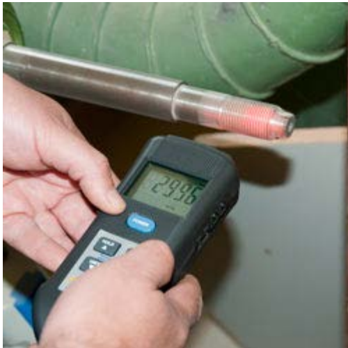
De Tachometer-Stroboscoop PCE-T 260 bij de optische toerentalmeting
