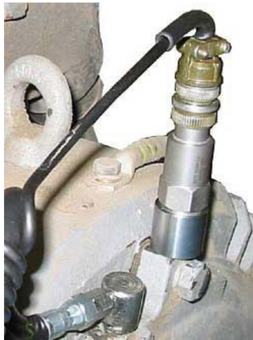
Hier ziet u de aansluitingsmogelijkheden van de oliekwaliteitsmeter.
