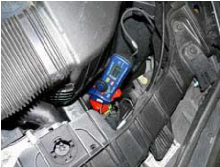
Gebruik van de multimeter ampèretang bij het meten van een voertuig.
