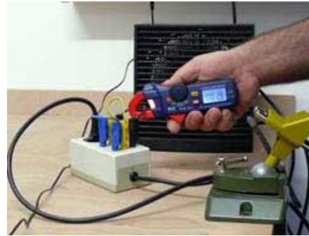
Spanningstest van een verdeelstekker met de multimeter ampèretang
