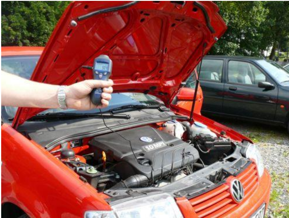
Zo kunt u de motor-toerentalmeter gebruiken: De inductieve transducer wordt op een ontstekingskabel geplaatst:
