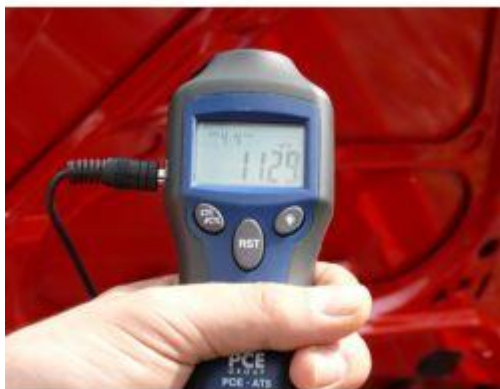
Zo kunt u de motor-toerentalmeter gebruiken: De inductieve transducer wordt op een ontstekingskabel geplaatst:
