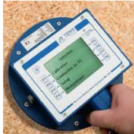
De microgolf-vochtmeter MW 1100 tijdens een meting
