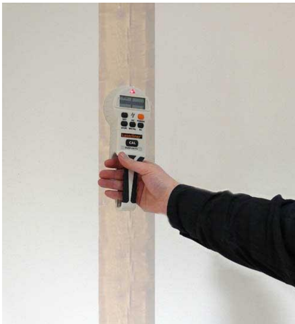
Detector tijdens inzet bij het zoeken van verborgen houtwanden in de wand.
