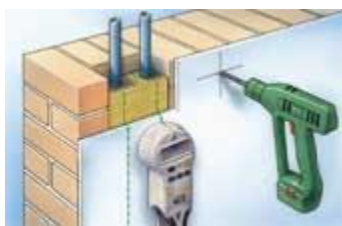
Metaal scanner tijdens inzet bij het zoeken van verborgen snoeren in de wand.
