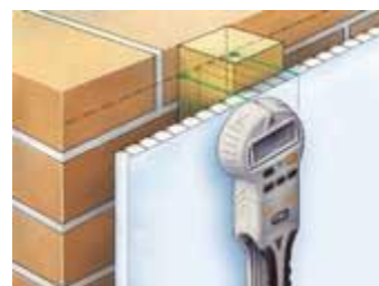
Metaal scanner tijdens inzet bij het zoeken van verborgen snoeren in de wand.
