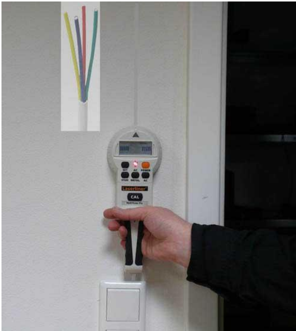
Metaal scanner tijdens inzet bij het zoeken van verborgen snoeren in de wand.
