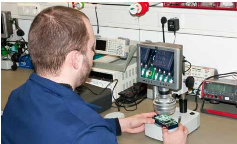
Hier ziet u de mechanische 3D-Microscoop bij onderzoek naar metalen componenten op de Display
