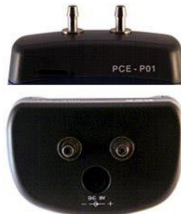
De aansluitingen van de differentieële barometer aan de bovenkant van het apparaat.
