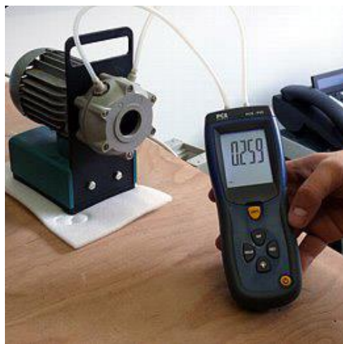
Hier ziet u de PCE-P01 bij het meten van differentieële druk van een vacuümpomp.
