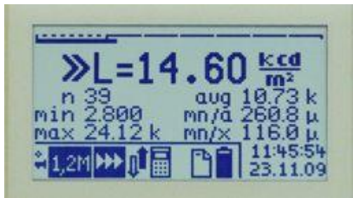
Lichtsterktemeter – Display weergave Lichtsterkte incl. weergave van de statistieken
