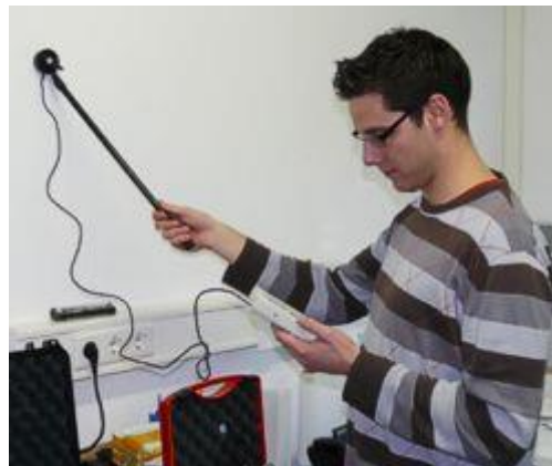
De PCE-L 100 met armverlenging (in leveromvang)
