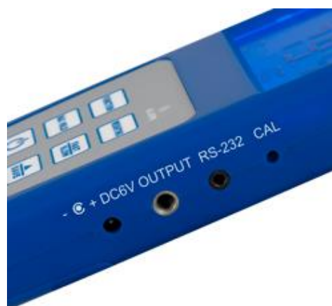
Hier ziet u de verschillende in-en uitgangen van onze LEQ-geluidsmeter
