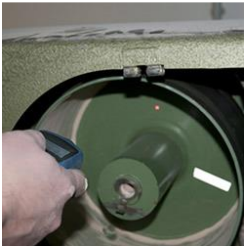
De laser tachometer tijdens een contactloze meting
