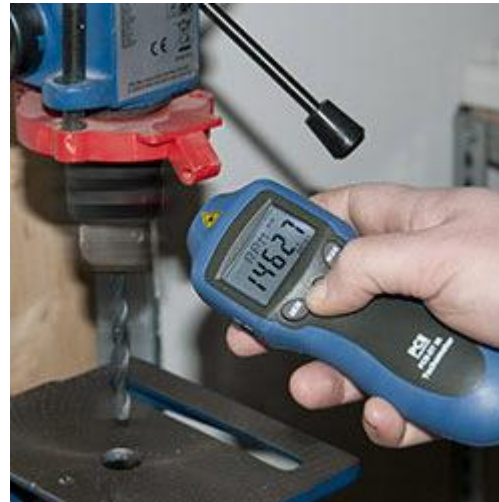
De laser tachometer tijdens een contactloze meting in een boor.
