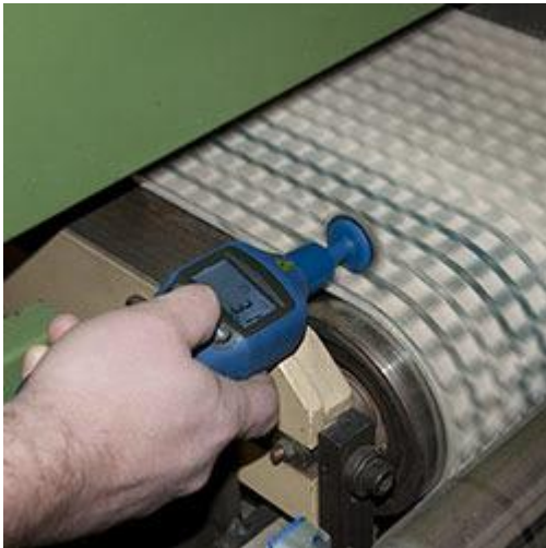
De laser tachometer tijdens een contactmeting op een transportband.
