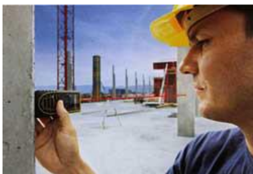
Leica Disto D5 laser-afstandsmeter met Power Range Technology, meting tot 100 m zonder testdoel.
