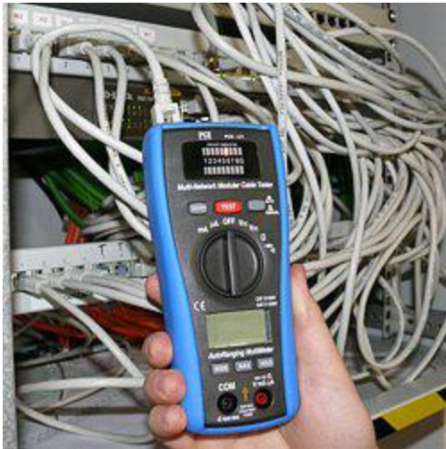
LAN Tester op zoek naar een netwerkfout
