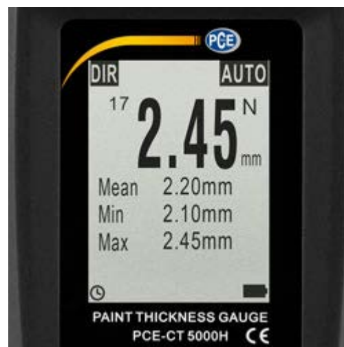
Het display van de laagdiktemeter bij de meting van non-Ferro-metaal (meting in mm).
