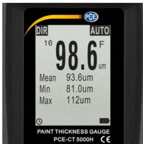
Het display van de laagdiktemeter bij de meting van Ferro-metaal (meting in µm).
