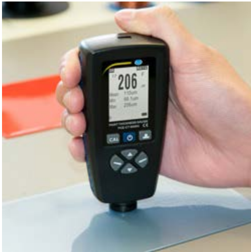
De Laagdijktometer PCE-CT 5000H bij de meting van Ferro-metaal.
