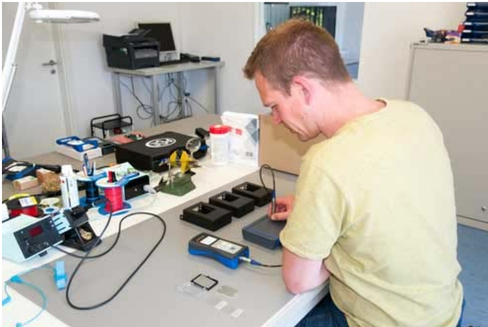
Hier is te zien hoe een laagdiktemeting wordt uitgevoerd met de Laagdiktemeter PCE-CT 100.
