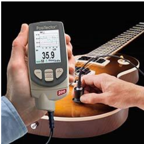
Hier kun je de Kleur Laagdijktometer PT-200 zien, die de lakdikte van een gitaar meet.
