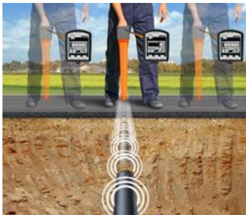
De Kabelzoeker Easyloc bij het lokaliseren van een in de grond gelegde lijn
