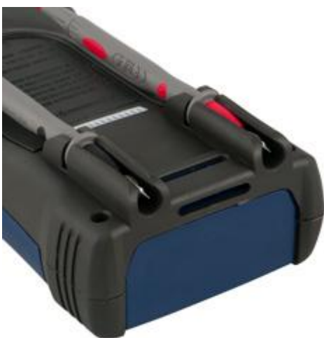
Aan de achterkant van de isolatie-multimeter bevinden zich de houders voor de sondes.
