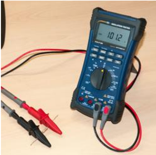
De isolatie-multimeter kan ook worden gebruikt om de weerstand te bepalen.
