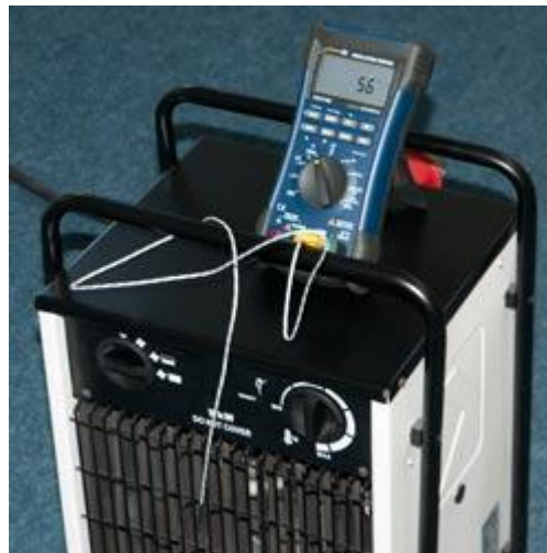
Naast de normale functies van het isolatie-multimeter kan ook een temperatuurmeting worden uitgevoerd.
