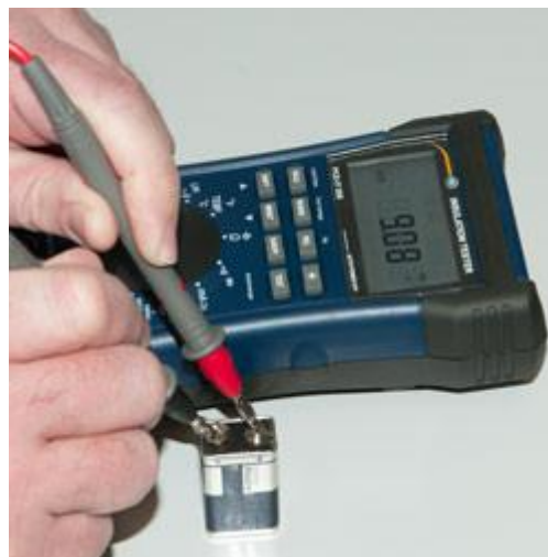
Een meting kan worden uitgevoerd na het aansluiten van de probes op de isolatie-multimeter.
