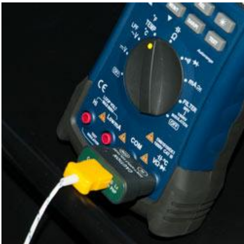
De isolatie-multimeter bevat een adapter waaraan het thermokoppel type K kan worden aangesloten.
