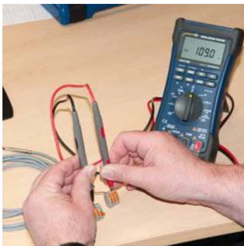
De weerstandsmeting is een van de vele functies van de isolatie-multimeter.
