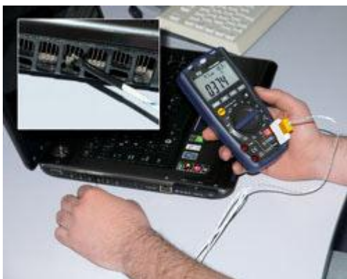
De multifunctionele meter bij het controleren van een temperatuurmeting met een K-type sensor
