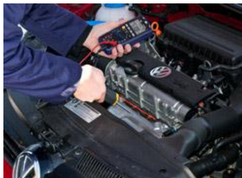
Temperatuurtest van een motor met de hygro-thermometer PCE-EM 886
