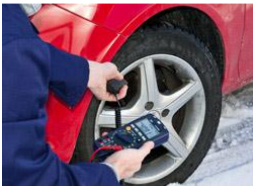
Temperatuurmeting met de externe infrarode temperatuuradapter
