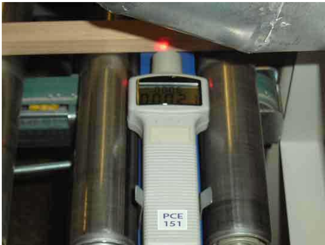
Hier ziet u de handheld tachometer PCE-151 bij een telling op een machine voor gesneden houtstroken
