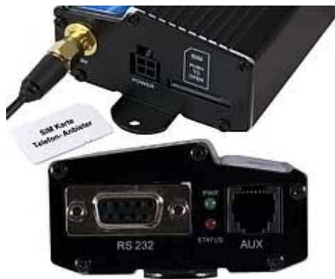
Hier ziet u de GPRS-overdrachtsmodule Rpipe met al zijn aansluitingen
