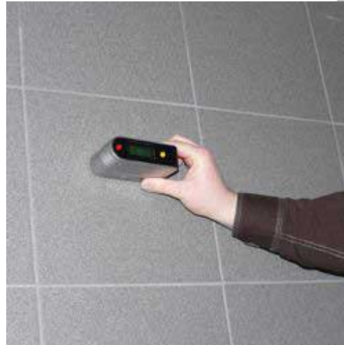
Hier ziet u de PCE-GM 50 glossmeter bij het meten van een betegeld oppervlak.
