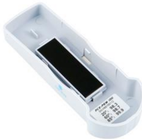
Glansgraad meter PCE-PGM 100 met kalibratie plaat
