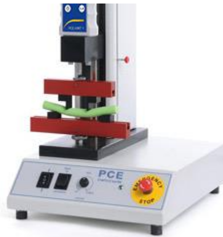
Gemotoriseerde trek-drukkraftmeter: optioneel beschikbare belastingbegrenzing
