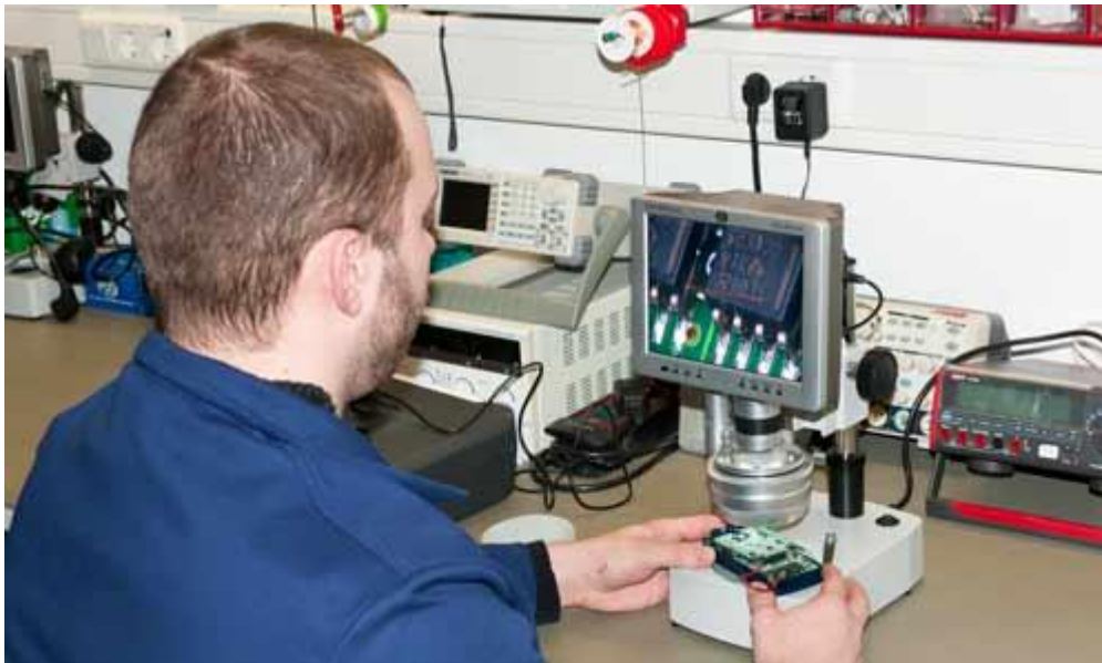
Hier ziet u de gemotoriseerde 3D-Microscoop bij het onderzoeken van een printplaat op de Display
