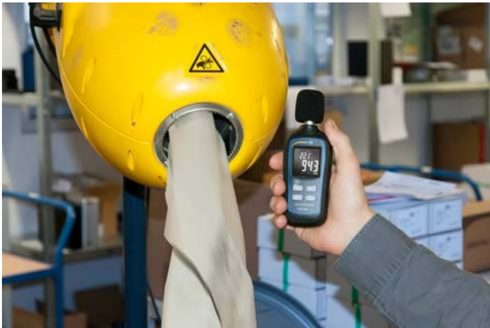
De Geluidsmeter PCE-MSL 1 bij het gebruik in een magazijn.
