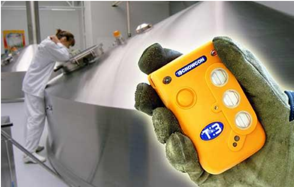
Gasmeter Tetra Mini bij gebruik in een brouwerij
