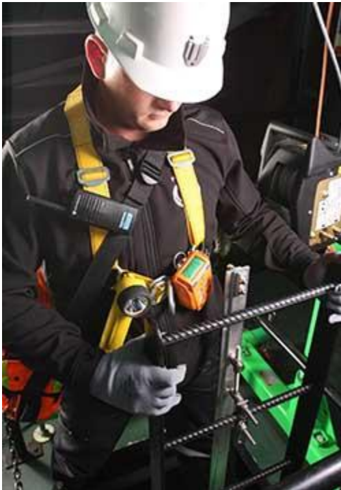
Gasmeter bij industrieel gebruik
