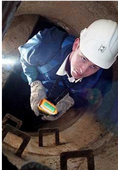
Gasmeter Gas-Pro voor het beschermen van personen bij werkzaamheden in bijvoorbeeld een riool
