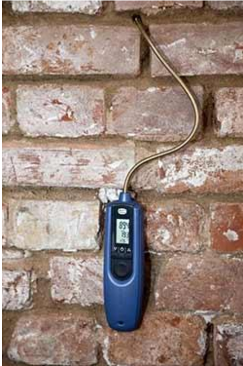
Evenwichtsvochtgehalte meter Hydromette BL Compact RH-T flex bij de meting in een voeg
