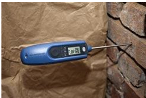
Evenwichtsvochtgehalte meter Hydromette BL Compact RH-T bij de meting van een boorgat
