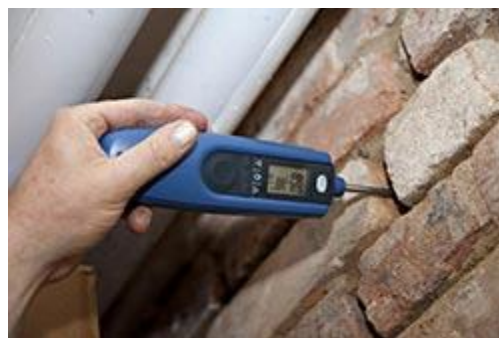
Evenwichtsvochtgehalte meter Hydromette BL Compact RH-T bij de meting van voegen
