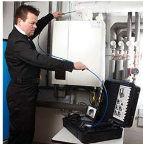
Hier ziet u de Endoscoop VIS 300/350 in gebruik bij een verwarmingssysteem
