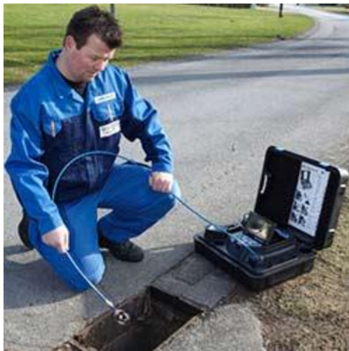
Hier ziet u de Endoscoop VIS 300/350 in gebruik bij een grachtsysteem
