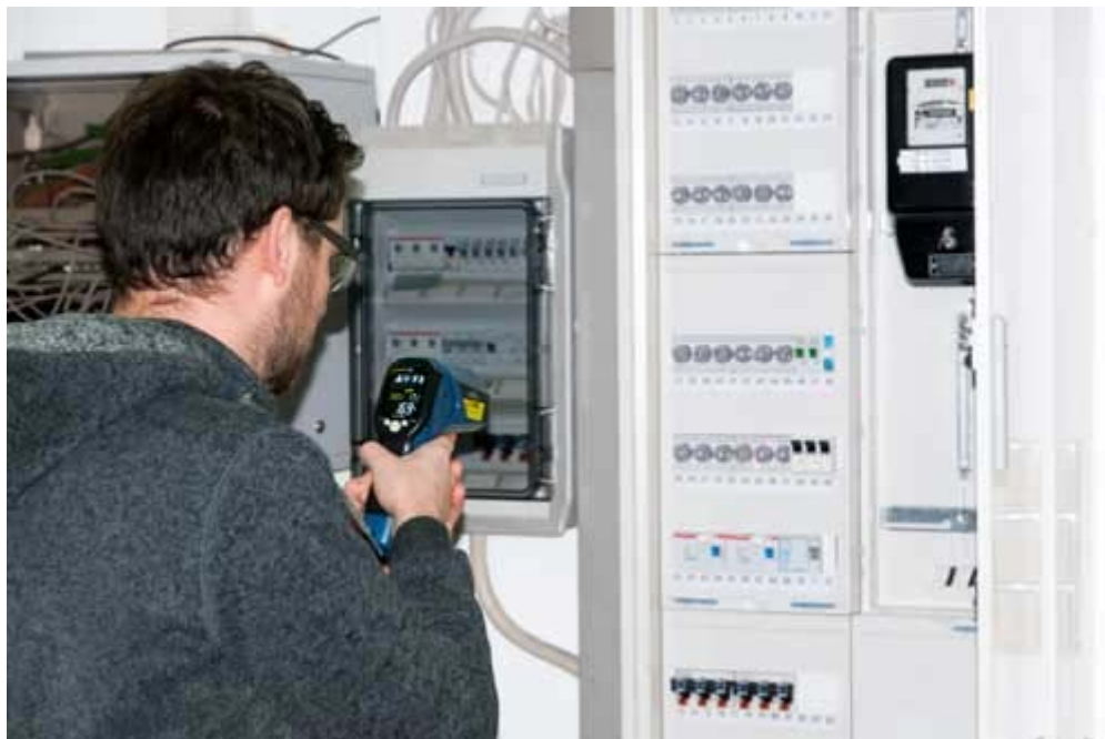
De PCE-895 in gebruik, bij de controle van zekeringen
