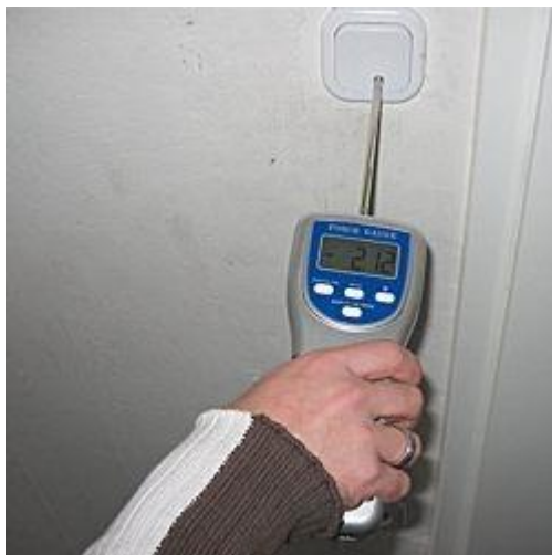
Drukkemeter bij het bepalen van de benodigde schakelkracht
