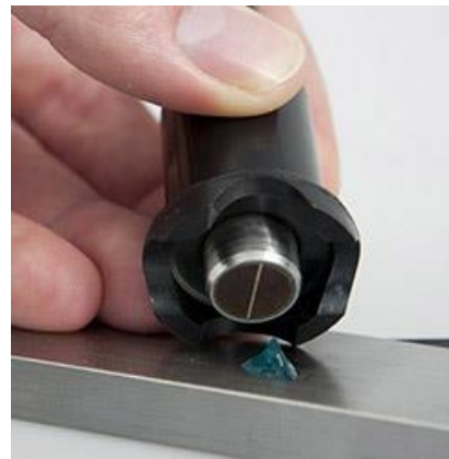
Diktemeter voor materialen bij het verrichten van een meting
