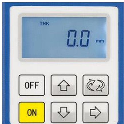
Hier ziet u de diktemeter met ingeschakelde meetmodus
