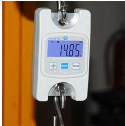
Het beeldscherm van de digitale laadhaak serie PCE-HS tijdens een weging
