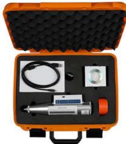
De uitgebreide leveromvang van de Digitale Betontest Hamer PCE-HT 225E.
