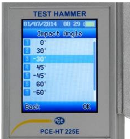
Instellen van de botshoek op het display van de Digitale Betontest Hamer PCE-HT 225E.
